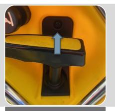
STEP 14: REMOVE THE SCREW FROM THE LOCATION SHOWN
